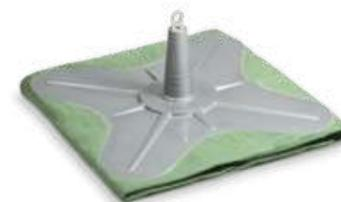
L'ancoraggio è costituito da un palo in acciaio inox con base circolare e di altezza 30 cm inserito all'interno di un cono rinforzato in fibra di vetro posto su una piastra ammortizzante e sul telo geotessile stabilizzante.
