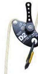
**Caratteristiche:** Discensore innovativo, leggero e piccolo, realizzato in acciaio inossidabile. Progettato per discesa di emergenza / evacuazione. Ha un doppio sistema di chiusura di sicurezza anti-panico che si attiva quando l'utente rilascia la leva e blocca automaticamente la discesa. Massima distanza di discesa: 120 metri. Capacità di carico: 100 kg / 140 kg (connessione diretta).
