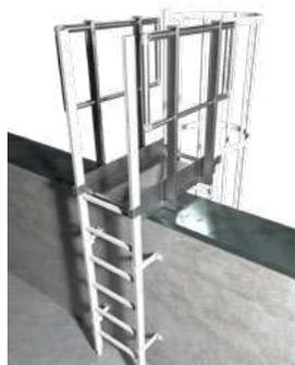
Passerella con piano di sbarco (larghezza utile 500 mm.) in alluminio con camminamento in lamiera bugnata, antiscivolo e drenante.
