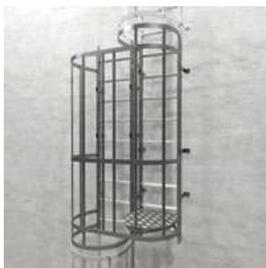
Ogni 6 metri (UNI EN ISO 14122-4 e D.Lgs. 81/08) di scala è obbligatorio per normativa interrompere la salita utilizzando un pianetto di riposo ribaltabile oppure un modulo di sdoppiamento dei tronchi. Per scale con altezza minore o uguale a 10 metri è consentita la realizzazione su tratto unico.
