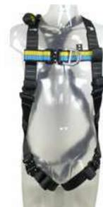
**Caratteristiche:** Imbracatura con 1 punto di ancoraggio dorsale e fascia di estensione + 1 punto di ancoraggio sternale. Cinta pettorale, fascia elastica e regolabile sulle spalle e cinta pelvica. Anelli in alluminio. Fibbie automatiche. Si fornisce con borsa Irusack 10L impermeabile.
