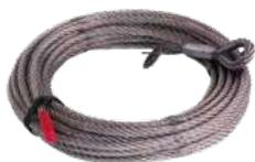
Fune in acciaio Inox AISI 316 Diam. 8mm con 133 fili. Fornita ad una estremità di occhiello chiuso con redance, manicotto in alluminio tronco conico e targhetta in alluminio con indicazione lotto di produzione.
