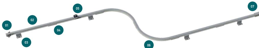
La nuova serie **R-STOP** della gamma REGO, nasce dall'esigenza di mettere in sicurezza tutte quelle coperture che per pendenze eccessive o con ridotto tirante d'aria non possono essere messe in sicurezza mediante una classica linea flessibile TIPO C. L'installazione avviene associando il binario ad un'ampia gamma di staffe, che possono adattarsi ad a svariati supporti.
