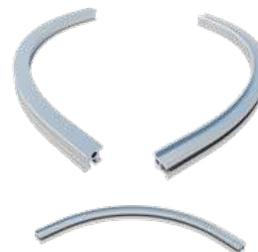
Curve per deviazioni angolari realizzate in lega di Alluminio 6063 preforati per installazione delle giunzioni. Verifica con prova in nebbia salina neutra UNI EN ISO 9227.
